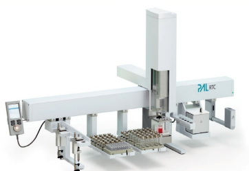
气相/气质自动进样暨前处理平台
