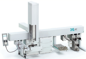
液相/液质自动进样暨前处理平台
